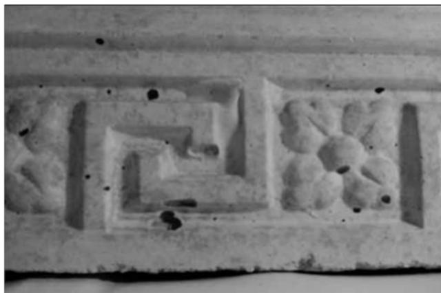
Рис. 1. Дефекты на поверхности изделия из бетона по технологии вибротлитья
