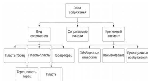
Рисунок 2. Структура узла сопряжения
